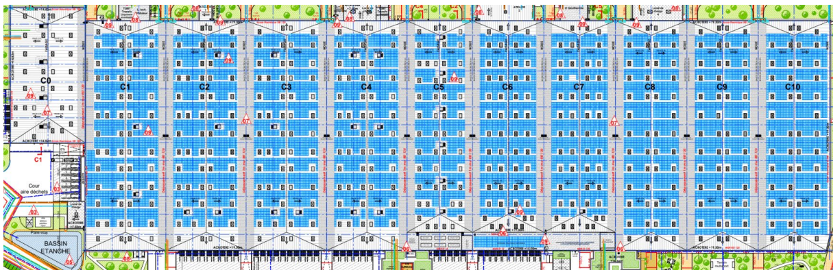
Figure 17 : Plan d'implantation des panneaux photovoltaïques
